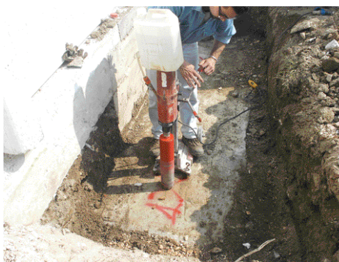
3. Prelievo di carote da un plinto di fondazione
