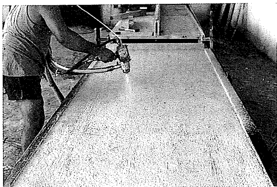
Foto 3 - Operazione di spruzzatura mediante il processo spray
